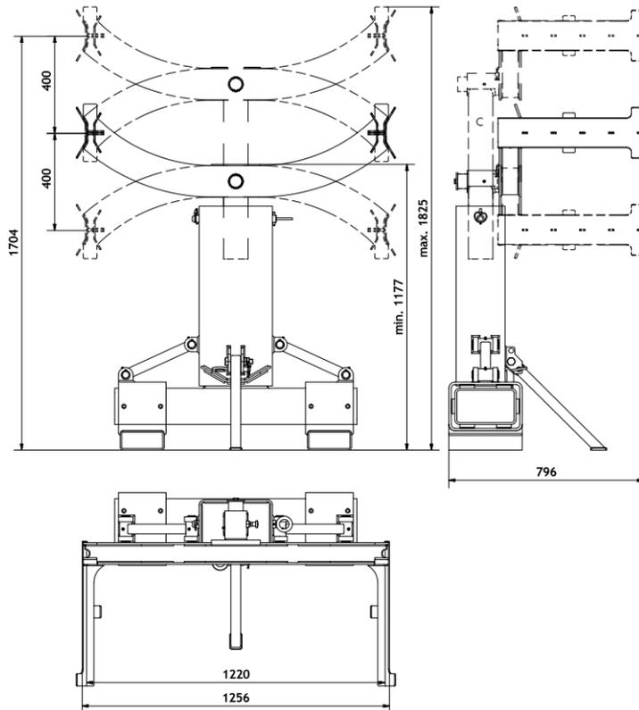
Bild: Abmasse Power-Spin PW1600
